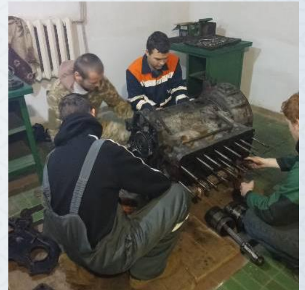
Ремонт двигуна СМД-14
